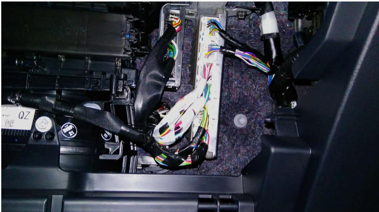
3. Открутить кронштейны крепления блока управления двигателем.
